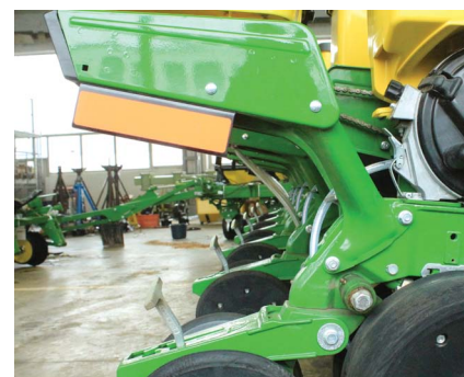
A kijuttatandó lémenyiséget a vezetőfülkéből szabályozzuk, nyomás függvényében
