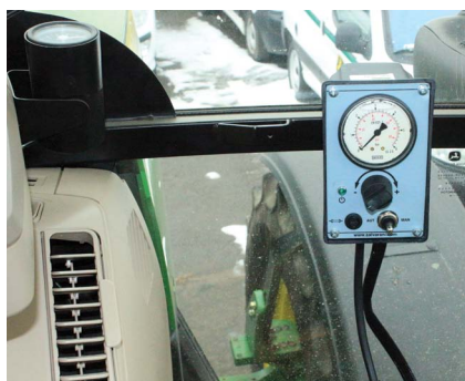
A kijuttatandó lémenyiséget a vezetőfülkéből szabályozzuk, nyomás függvényében
