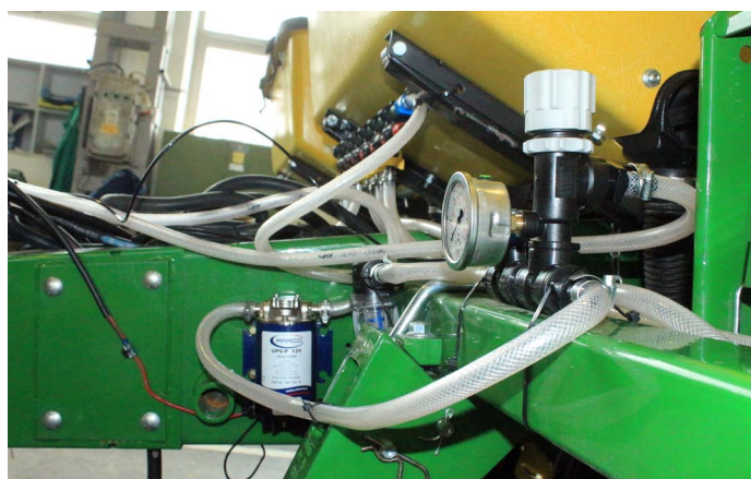
A szivattyú tartályból – a szűrőn keresztül – szívja a BactoFil®-t.
